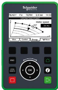
Терминал с графическим дисплеем (пример — сравнение динамических характеристик работающего насоса с теми же характеристиками при оптимальной работе)
