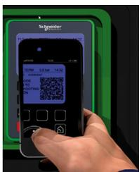
Сканирование QR-кода с помощью смартфона или планшета
